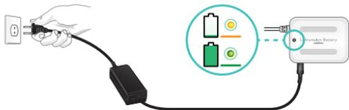
Durante el proceso de carga, el indicador LED de la batería se mostrará en amarillo fijo. Cuando la batería esté totalmente cargada, el indicador LED se mostrará en verde fijo.
