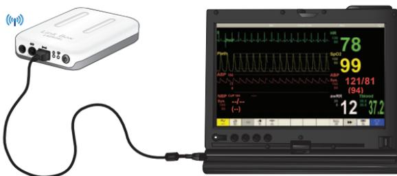
El software del monitor debe conectarse al Link Box deseado a través de una conexión de red, por cable o inalámbrica.
