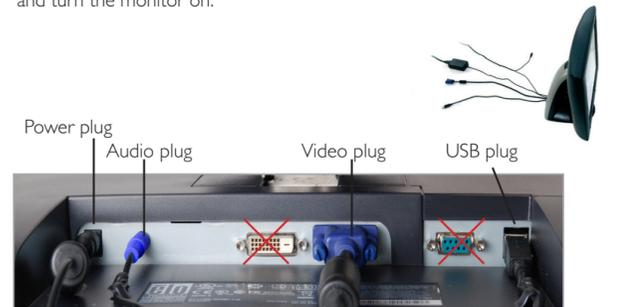
**4 CONNECTING THE MONITOR CABLES TO THE COMPUTER**
