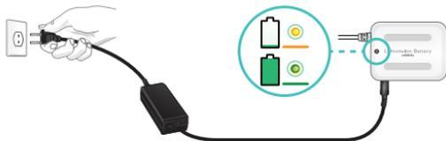
充電中、バッテリーの LED インジケータは黄色に点灯します。バッテリーがフル充電されると、LED インジケータは緑色に点灯します。
